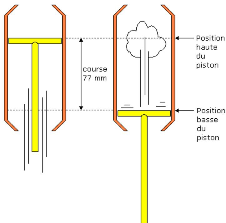
La cylindrée d'un moteur est le volume déterminé par la course des 4 pistons. Renault annonce que la Renault 9 a une cylindrée de  $1397 \text{ cm}^3$ .
